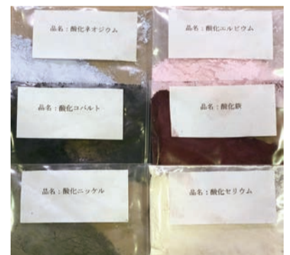
ガラスの原料となるさまざまな化学薬品。正確な配合技術が求められる
